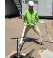
ホースが伸びきるまでの間、ホースが引かれすぎないようにホースを押さえる
