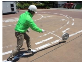
2本目のホースと管そうを持って、一本目のホースが伸びきる地点付近に移動し、2本目のホース延長
